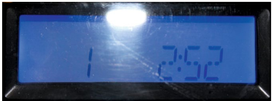
Bild 2: Kunststoffscheiben aus PC oder PMMA weisen gewöhnlich eine nur ungenügende Kratzfestigkeit auf
